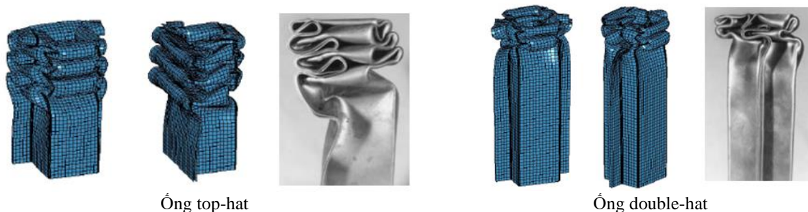
Hình 7: Biến dạng của cấu trúc ống tubular-hat chịu tải và đập dọc trục
