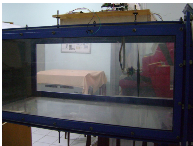
Hình 7: Hệ thống thực nghiệm đặc tính hoạt động của chong chóng khí dùng cho máy bay không người lái loại nhỏ
