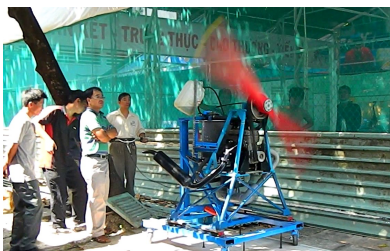
Hình 8: Hệ thống thử nghiệm đặc tính lực đẩy tĩnh của chong chóng khí dùng cho điều khiển có động cơ
