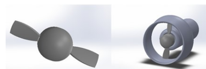
Hình 13: Hình học của thiết bị đẩy BTĐ-150 của LBV150 ROV SeaBotix
