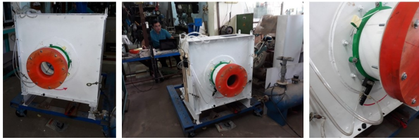
Hình 15: Thử nghiệm đặc tính hoạt động của quạt ly tâm công suất 5.5 kW của Công ty Đồng Tâm
