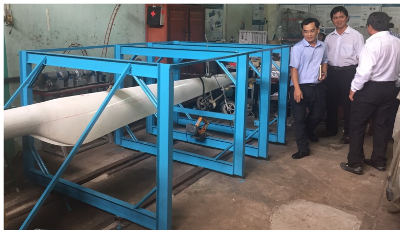
Hình 21: Hệ thống thử nghiệm bền kết cấu cánh của máy phát điện gió trục ngang loại nhỏ
