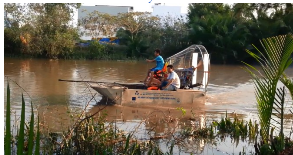
Hình 2: Thử nghiệm thuyền lướt khí ba chỗ ngồi tại Nhà Bè
