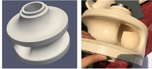
Hình 17: Hình học của bánh công tác của "fish friendly pump" Z65L của hãng Matsusaka
