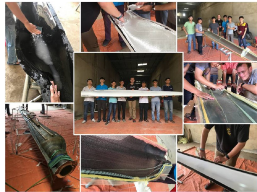
Hình 20: Chế tạo cánh thu nhỏ của cánh DeVie Wind Turbine tại HCMUT-VNU với sự chuyên gia của chuyên gia từ Viện Fraunhofer IWES
